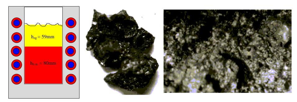
Steel: C = 0.2%; quantity = 2 kg; CaO = 50%;  $SiO_2 = 25\%$ ; FeO = 25%;  $I_B = 2$ ; quantity = 0,2 kg;
