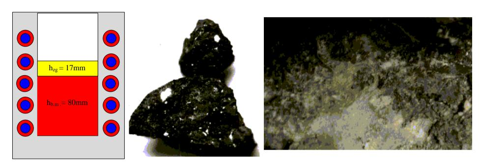
C=0,2%; quantity = 2 kg; CaO=50%;  $SiO_2=25\%;$  FeO=25%;  $I_B=2;$  quantity = 0,2 kg;
